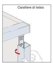
Esempio di montaggio a scorrimento superiore
