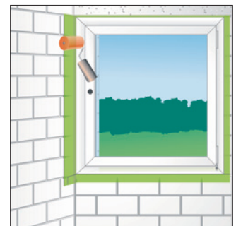
Bild 4: Folie mit Andruckroller anrollen
