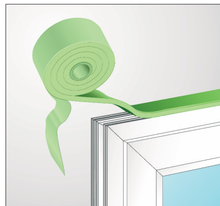
Bild 2: Komplette Abdichtung in einem Arbeitsschritt
