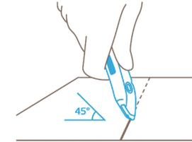
Zum Schneiden von Kartons das Schneidwerkzeug **leicht schräg** halten.
