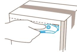
Mit der Messernase **stechen** Sie ins Schneidmaterial ein. **Nicht** hebeln in verstärkten Kartonecken und an Metallklammern!
