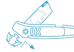
Halten Sie die Ersatzklinge **parallel** vor den unteren Griffbereich und setzen Sie sie ein. Danach Klingenkopf bis zum Anschlag **nach rechts** bewegen.
