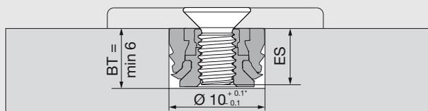
Per EXPANDO T singolo devono essere usate viti con filettatura M4.
