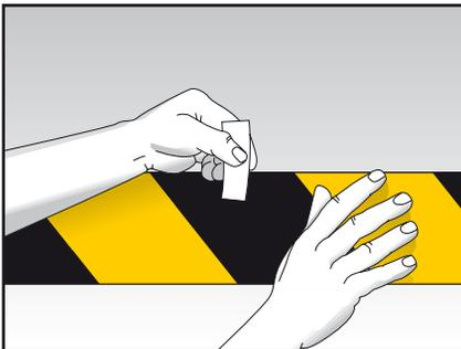
② Folie an der zu markierenden Oberfläche ausrichten, ggf. mit Klebestreifen an Hilfslinien positionieren und den Folienteil ohne Schutzpapier mit Plastikraker andrücken.
