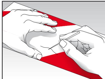
⑥ Eventuell entstandene Blasen mit einer Nadel punktieren und die Luft herausdrücken.
