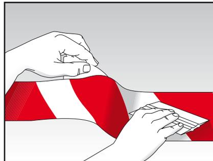
③ Schutzpapier langsam unter der Folie abziehen und gleichzeitig mit Plastikraker andrücken.
