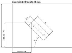
Mindestabmessung des Ausschnitts am beweglichen Teil. Maximale Einfrästiefe 24 mm.
